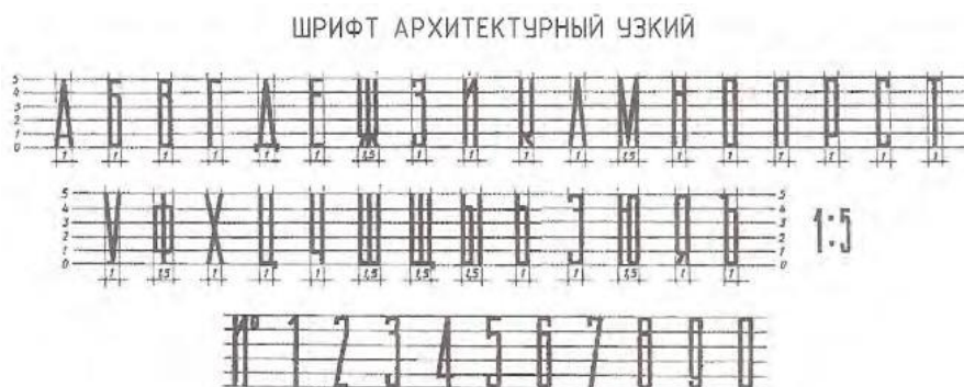
Рис. 14. Шрифты чертежные: а — стандартный; б — узкий архитектурный
