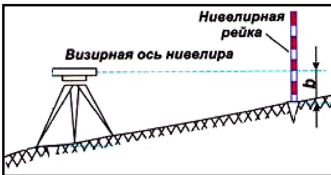
Рис. 4.4 Исследование разности высот нулей пары реек
