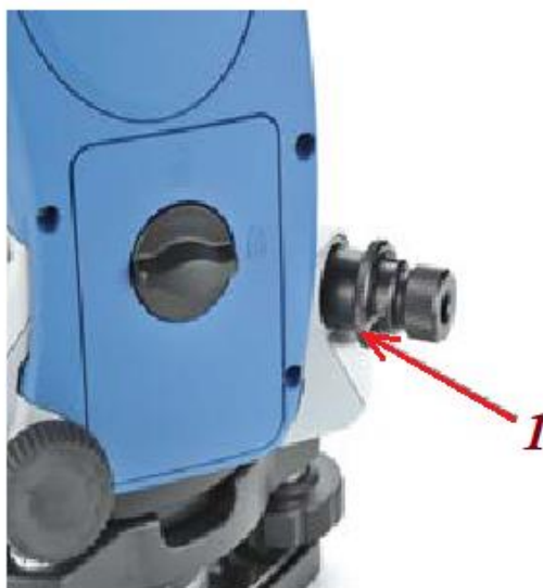
Рис. 6.3 Юстировка оптического центрира тахеометра
