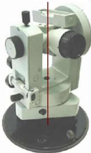
Рис. 1.23 Приведение оси вращения теодолита в отвесное положение
