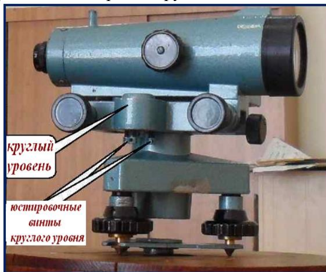
Рис. 3.8 Круглый уровень с юстировочными винтами нивелира
