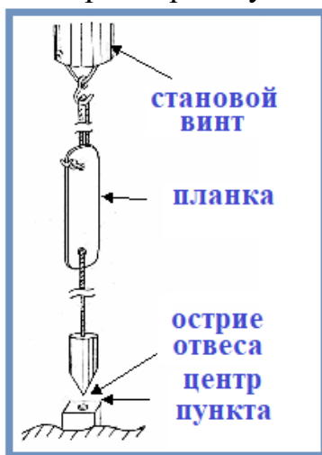
Рис. 1.22 Центрирование теодолита
