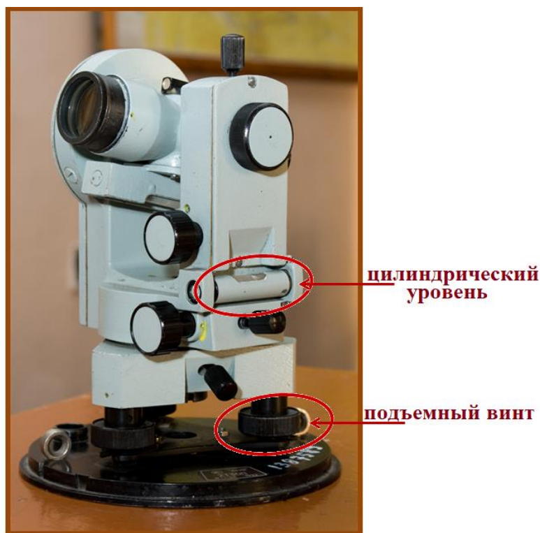
Рис. 1.8 Цилиндрический уровень и подъемные винты теодолита
