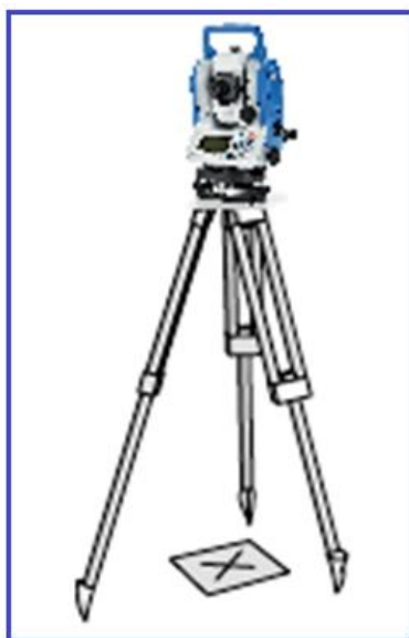
Рис. 6.1 Поверка оптического центра тахеометра
