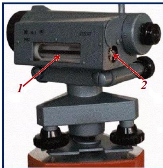
Рис. 3.9 Цилиндрический уровень нивелира с юстировочными винтами
