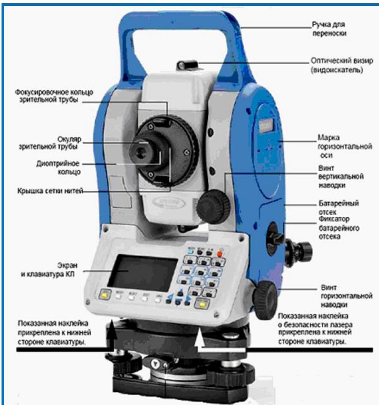
Рис. 5.4 Основные винты и детали тахеометра Focus 6
