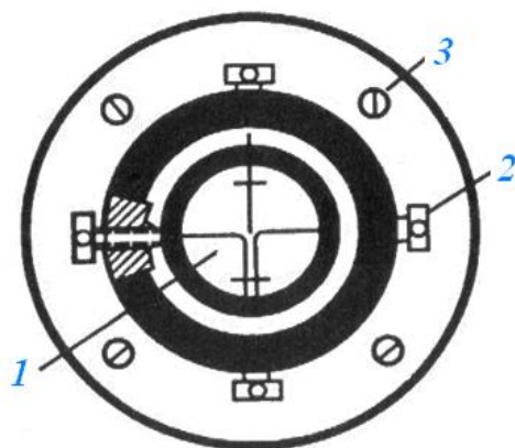
Рис. 1.6 Юстировочные и крепежные винты сетки нитей
