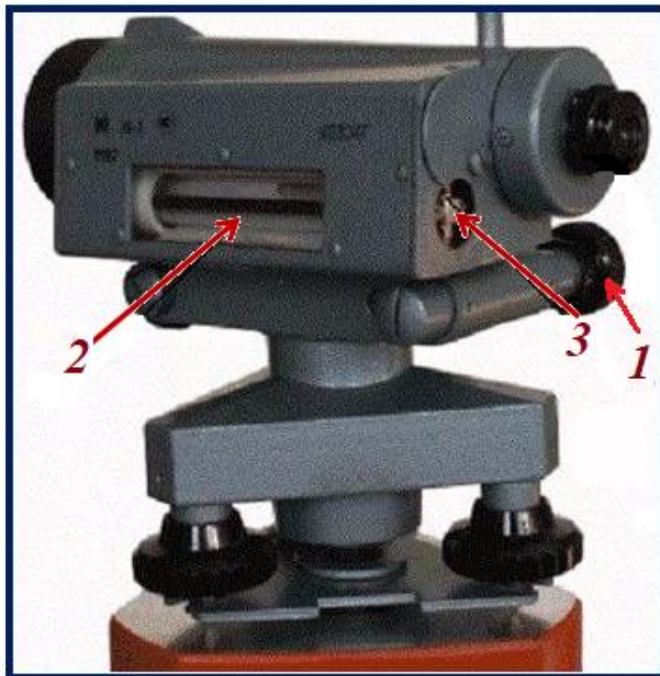
Рис. 3.21 Юстировка цилиндрического уровня нивелира
