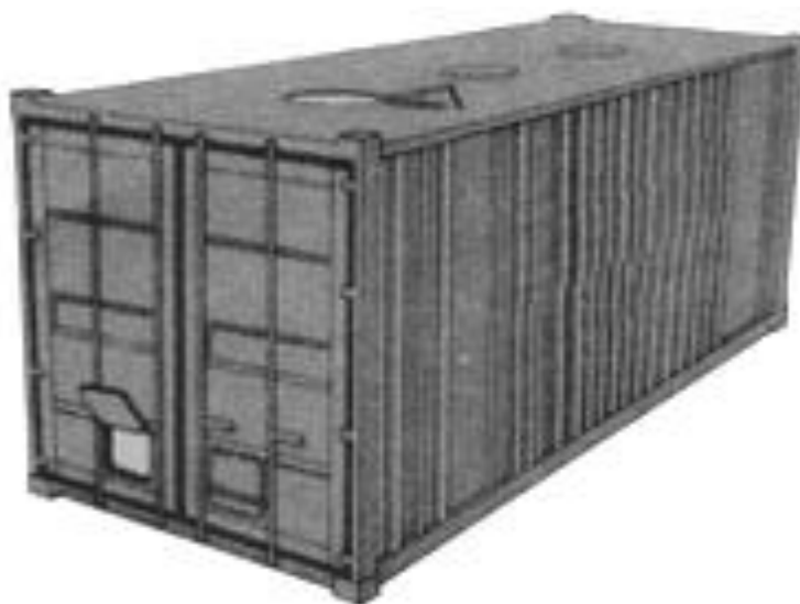
Рис. 3.1. 20-футовый контейнер для насыпных грузов Параметры контейнера представлены в табл. 3.1.
