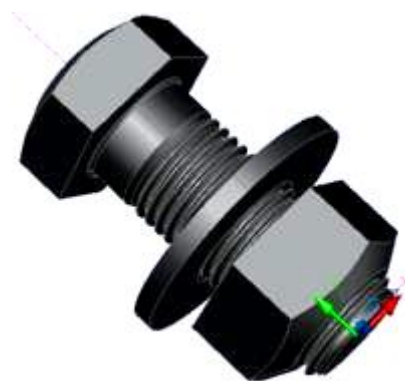
Рисунок 13 – Трехмерная модель резьбового соединения
