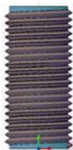
Рисунок 5 – Построение резьбовой поверхности (вид спереди)
