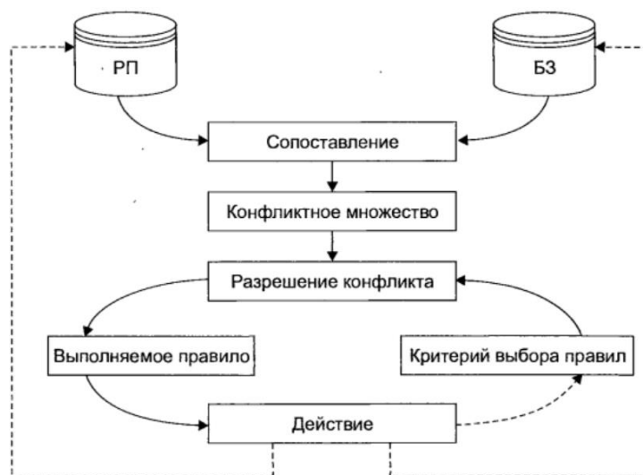
Рис. 4.1. Схематическое изображение процесса вывода в продукционных системах
