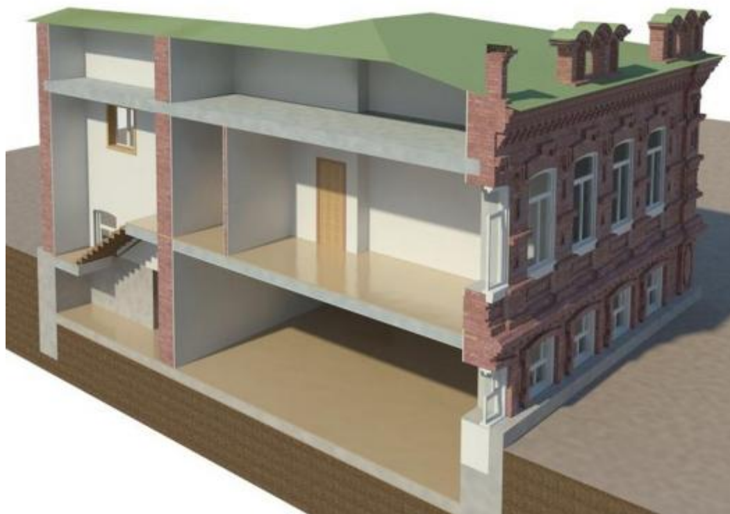
Рис. 1.5. Трехмерный разрез здания
