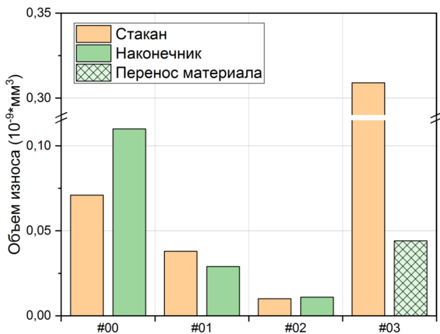
Рисунок 4.7 – Гистограмма распределения объема износа трущихся сопряжений шлицевой муфты при режимах стендовых испытаний 24 300 Н, 500 000 циклов
