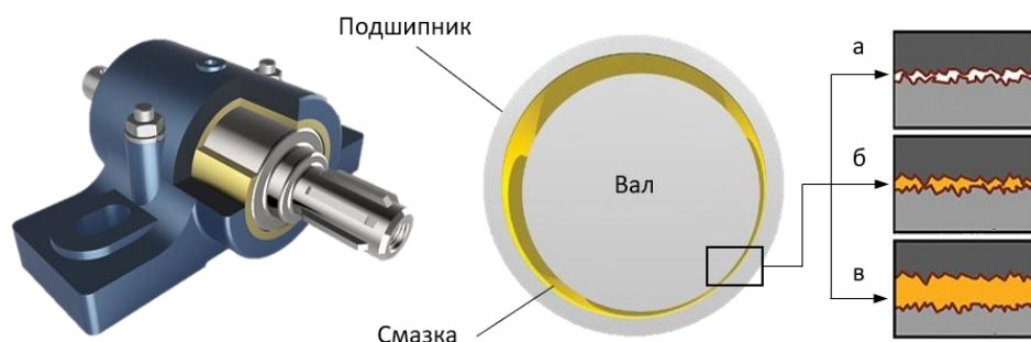
Рисунок 1.1. Устройство пары трения с подшипником скольжения и схематическое представление сухого (а), граничного (б) и жидкостного (в) трения
