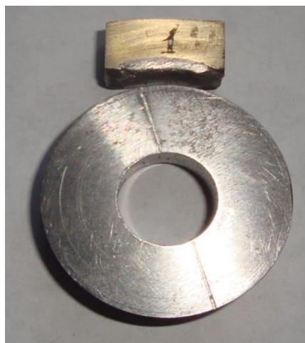
Рисунок 4.8 – Комплект образцов: колодка с покрытием и ролик для машины трения
