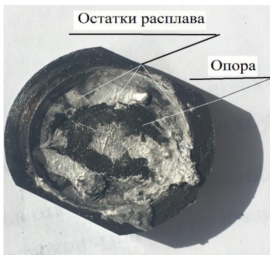
Рисунок 5.4 – Опорная поверхность упорного подшипника после стендовых испытаний ( V = 2 м/с; \sigma = 2 МПа)
