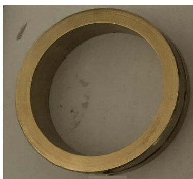
Рисунок 4.9 – Втулка-образец для стенда на основе токарно-винторезного станка
