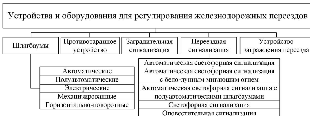
Рисунок 2.13 – Устройства и оборудования для регулирования переездов
