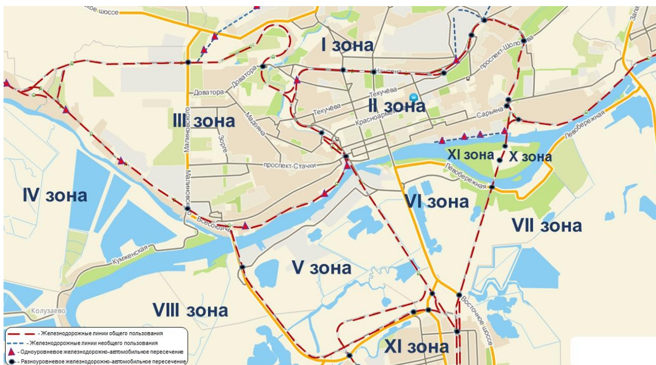
Рисунок 2.3 – Железнодорожная инфраструктура, формирующая барьеры развития территории и обеспечения мобильности населения (г. Ростов-на-Дону)
