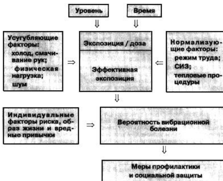
Рис. 7.1. Схема формирования эффективной экспозиции локальной вибрации и вероятность вибрационной болезни
