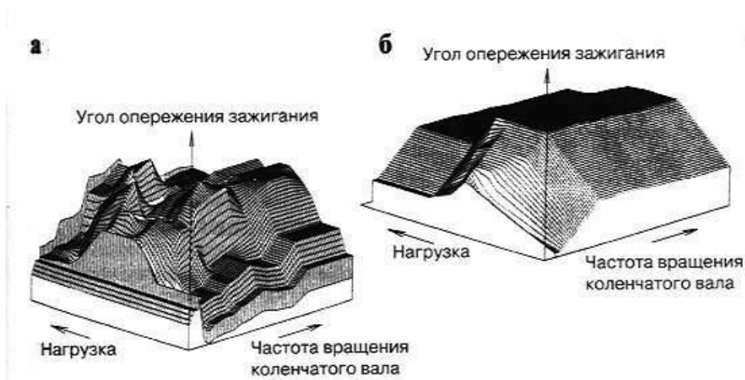
Рисунок 2.11 – Диаграммы углов опережения зажигания
