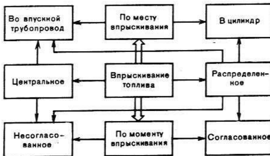
Рисунок 2.7 – Классификация способов впрыска топлива
