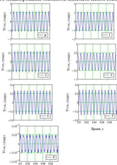
а – ротора двигателя; б – ведущей шестерни 1; в – ведомой шестерни 2; г – ведущей шестерни 3; д – ведомой шестерни 4; е – рабочего органа 5; ж – рабочего органа 6
