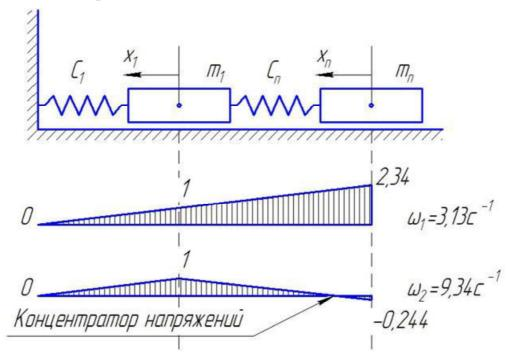
Рис. 1.6 — Приведенная расчётная схема механической системы поступательно движущихся масс (a) и формы, частоты собственных колебаний ( $\delta$ )
