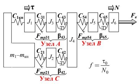
Рис. 1 - Кинематическая схема объекта с фрикционными узлами трения А, В и С
