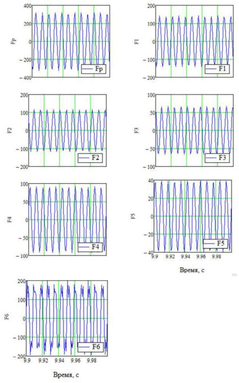
а — ротора двигателя; б — ведущей шестерни 1; в — ведомой шестерни 2; г — ведущей шестерни 3; д — ведомой шестерни 4; е — рабочего органа 5; ж — рабочего органа 6
