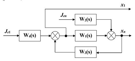
Рис. 1.7 – Структурная модель механической системы
