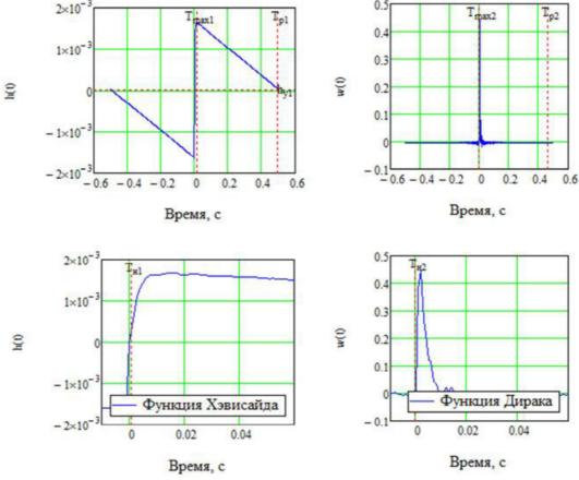
a — переходной функции Хэвисайда h(t) — отклика объекта на единичную функцию включения 1(t);  $\delta$  — импульсной функции Дирака w(t) — отклика объекта на импульсную ударную функцию  $\delta(t) = 1'(t)$
