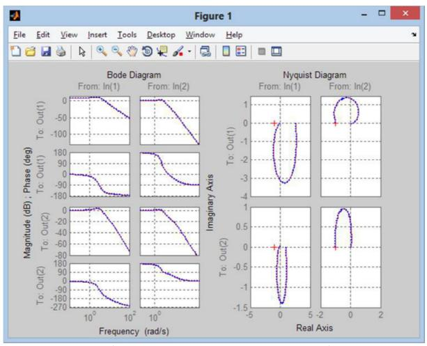
Рис. 1.8 – Логарифмические амплитудно-частотные и фазово-частотные характеристики (а); амплитудно-фазовочастотные характеристики (б)
