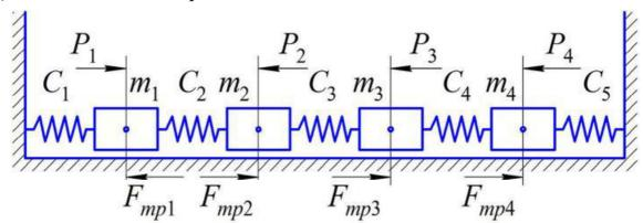
Рис. 1.1 – Схема задания поступательно движущихся масс
