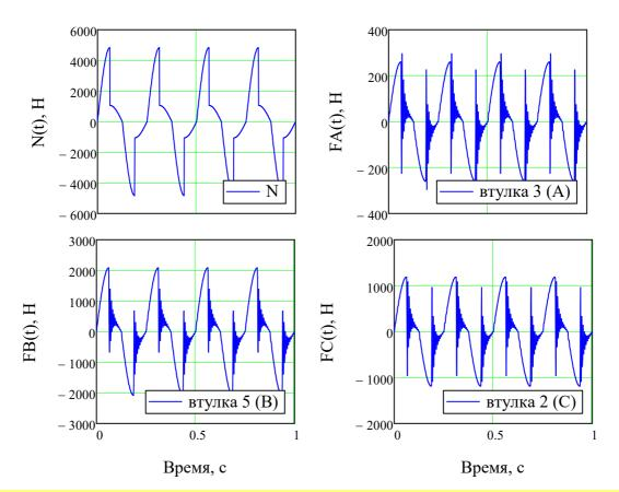
Рис. 3 - Временные характеристики нагрузки внешнего воздействия ( $\pmb{a}$ ) и упруго-диссипативных связей при амплитуде внешнего воздействия  $\pmb{y}_0 \cdot 1000 = 0.5~$  мм, частоте колебаний  $\pmb{\omega} = 4~$  Гц и коэффициенте демпфирования колец 2, 3, 5  $\pmb{\xi} = 0.1~$ :  $\pmb{\delta}$  - кольцевой втулки 3 (ось A);  $\pmb{\varepsilon}$  - точки крепления вертикальной тяги 6 (ось B);  $\pmb{\varepsilon}$  - кольцевой втулки 2 (ось C)
