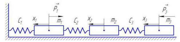
Рис. 1.2 – Расчётная схема исходной механической системы поступательно движущихся масс
