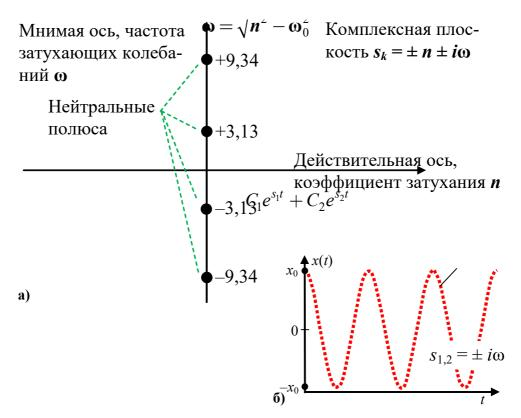
Рис. 1.5 — Полюса (•) на комплексной плоскости (a) и соответствующие им вид свободного (невозбуждённого) движения ( $\delta$ ) от ненулевого начального положения  $x_0$
