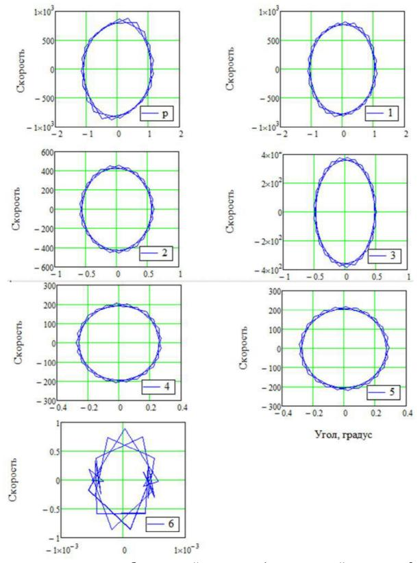
а – ротора двигателя; б – ведущей шестерни 1; в – ведомой шестерни 2; г – ведущей шестерни 3; д – ведомой шестерни 4; е – рабочего органа 5; ж – рабочего органа 6
