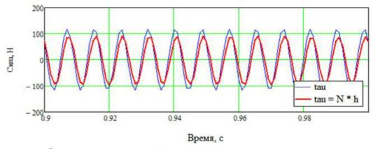
а — по расчёту; б — по вещественной частотной характеристике, то есть отклик  $\tau(t)$  по заданному внешнему воздействию N(t) и переходной функции Хэвисайда
