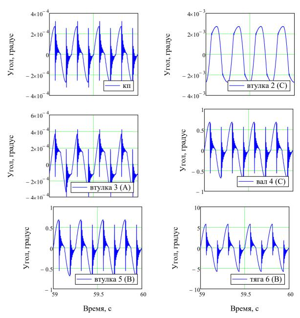
Рис. 1 - Функции угловых смещений модели объекта во времени при амплитуде внешнего воздействия  $\mathbf{y_0} \cdot 1000 = 0.5\,$  мм, частоте колебаний  $\boldsymbol{\omega} = 4\,$  Гц и коэффициенте демпфирования колец 2, 3, 5  $\boldsymbol{\xi} = 0.1\,$ :  $\boldsymbol{a}$  - полукольцевой пружины 1;  $\boldsymbol{\delta}$  - кольцевой втулки 2 с осью C;  $\boldsymbol{e}$  - кольцевой втулки 3 с осью A;  $\boldsymbol{e}$  - вертикальной тяги 6 с осью B
