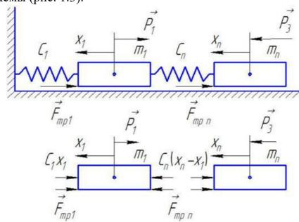
Рис. 1.3 — Приведенная расчётная схема механической системы поступательно движущихся масс (a) и силы, действующие в ней ( $\delta$ )
