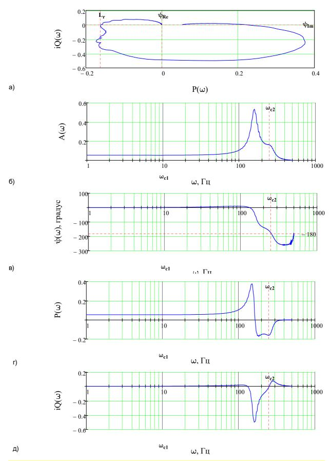
Рис. 6 - Частотные характеристики периодограммным методом Уэлча с использованием весового окна Гаусса при амплитуде внешнего воздействия  $y_0 \cdot 1000 = 0.5~$  мм, частоте колебаний  $\omega = 4~$  Гц и коэффициенте демпфирования колец 2, 3, 5  $~\xi = 0.1~$
