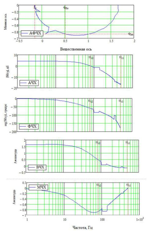
a — амплитудная фазовая частотная характеристика (АФЧХ);  $\delta$  — амплитудная частотная характеристика (АЧХ);  $\epsilon$  — фазовая частотная характеристика (ФЧХ);  $\epsilon$  — вещественная частотная характеристика (ВЧХ);  $\delta$  — мнимая частотная характеристика (МЧХ)
