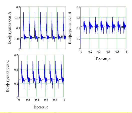
Рис. 4 - Временные характеристики коэффициента трения при амплитуде внешнего воздействия  $\mathbf{y_0} \cdot 1000 = 0.5~$  мм, частоте колебаний  $\boldsymbol{\omega} = 4~$  Гц и коэффициенте демпфирования колец 2, 3, 5  $\boldsymbol{\xi} = 0.1~$ :  $\boldsymbol{a}$  - кольцевой втулки 3 (ось A);  $\boldsymbol{\delta}$  - точки крепления вертикальной тяги 6 (ось B);  $\boldsymbol{e}$  - кольцевой втулки 2 (ось C)
