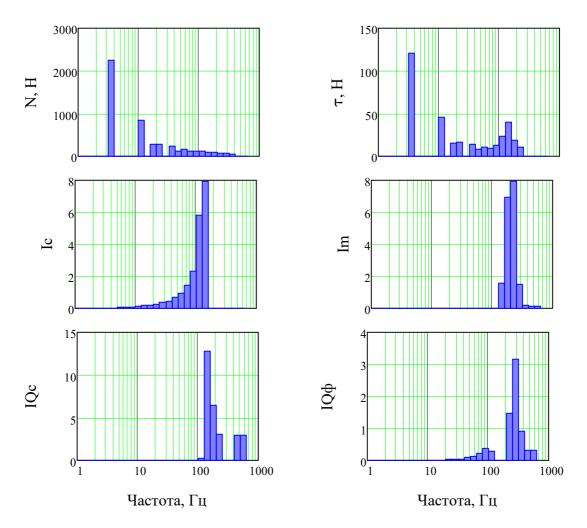
Рис. 8 - 1/ $\mathbf{B}=3$  - долеоктавные спектры среднего квадратичного отклонения:  $\mathbf{a}$  - вертикальной нагрузки;  $\mathbf{6}$  - силы нормального воздействия;  $\mathbf{e}$  - силы тангенциального смещения;  $\mathbf{e}$  - упругих нагрузок на объект;  $\mathbf{d}$  - инерционных воздействий на объект;  $\mathbf{e}$  - сил сопротивления колебаниям объекта;  $\mathbf{w}$  - сил трения, обусловленных фрикционными автоколебаниями
