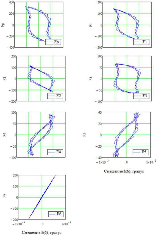
а — ротора двигателя; б — ведущей шестерни 1; в — ведомой шестерни 2; г — ведущей шестерни 3; д — ведомой шестерни 4; е — рабочего органа 5; ж — рабочего органа 6
