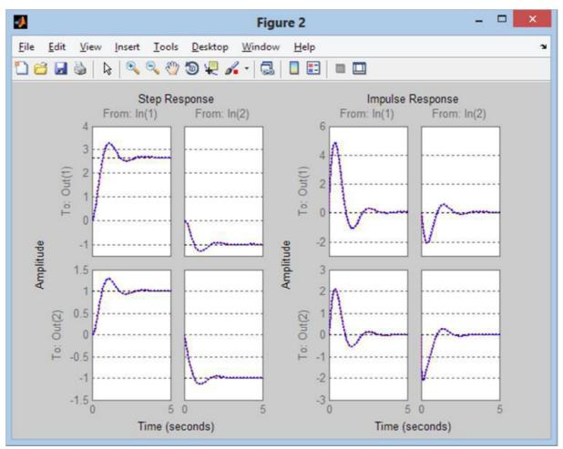
Рис. 1.9 — Временные характеристики системы: а — переходная функция Хэвисайда (или функция включения); б — импульсная функция Дирака (или функция удара)
