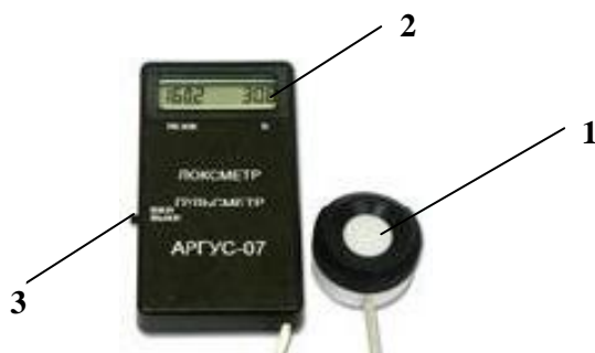
Рис. 1.1. Люксметр-пульсметр «Аргус-07»: 1 – фотоэлемент; 2 – жидкокристаллический экран; 3 – тумблер включения-выключения
