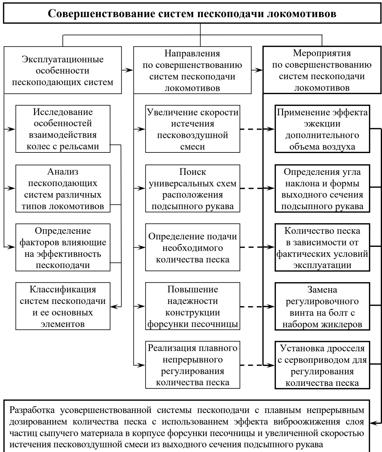
Рисунок 1.10 – Структура исследований совершенствования пневматической системы пескоподачи локомотивов
