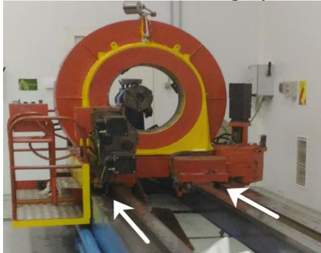
Рисунок 12 - Каретки станка для намотки лонжеронов
