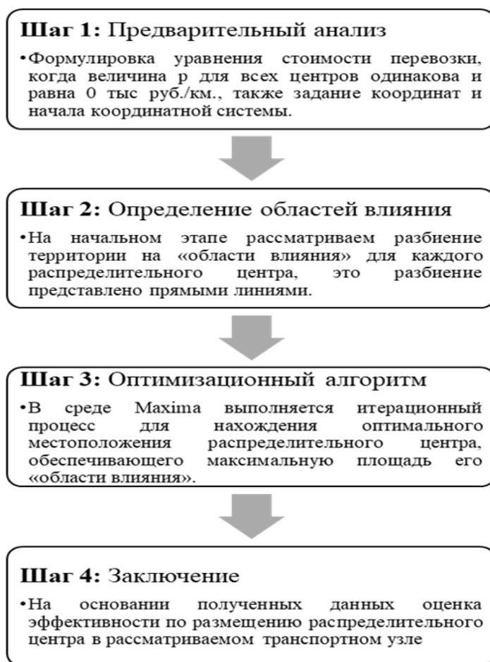
Рисунок 3.2 – Блок-схема последовательности решения задачи размещения ЛГРЦ
