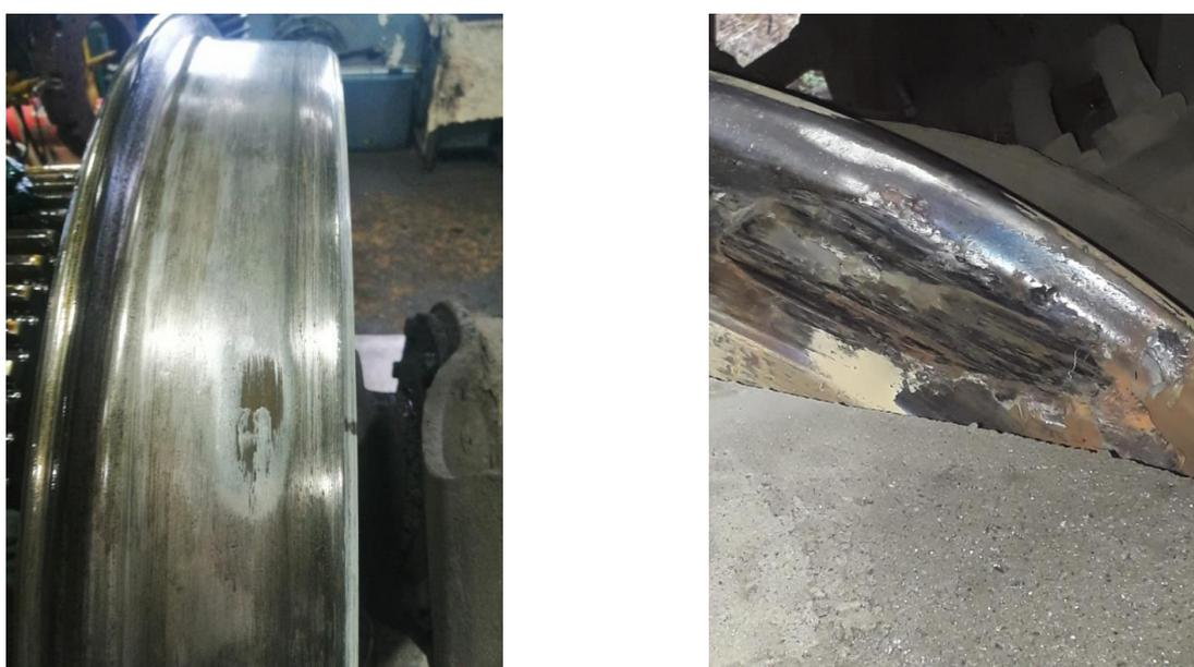
Рис. 1.9 Ползуны на поверхности катания бандажа электровоза 3ЭС5К
