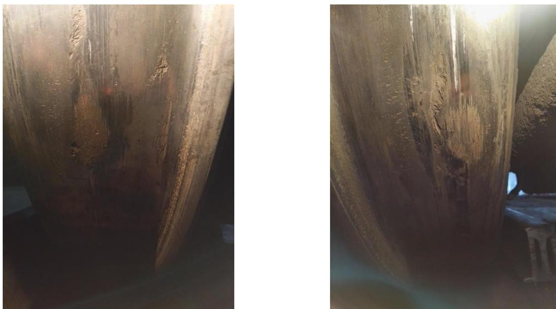
Рис. 1.8 Выкрашивание поверхности катания бандажа электровоза 3ЭС5К
