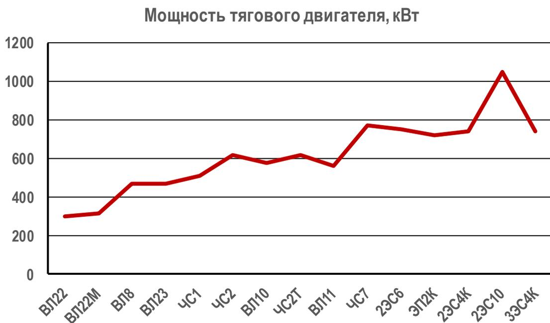
Рис. 1.2 Мощность тяговых двигателей, применяемых на отечественных электровозах постоянного тока в продолжительном режиме работы
