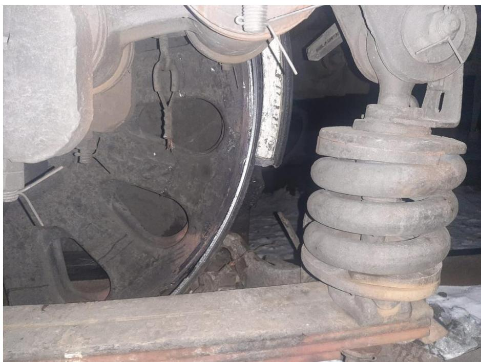
Рис 1.12 Разрыв бандажа грузового электровоза ВЛ80С
