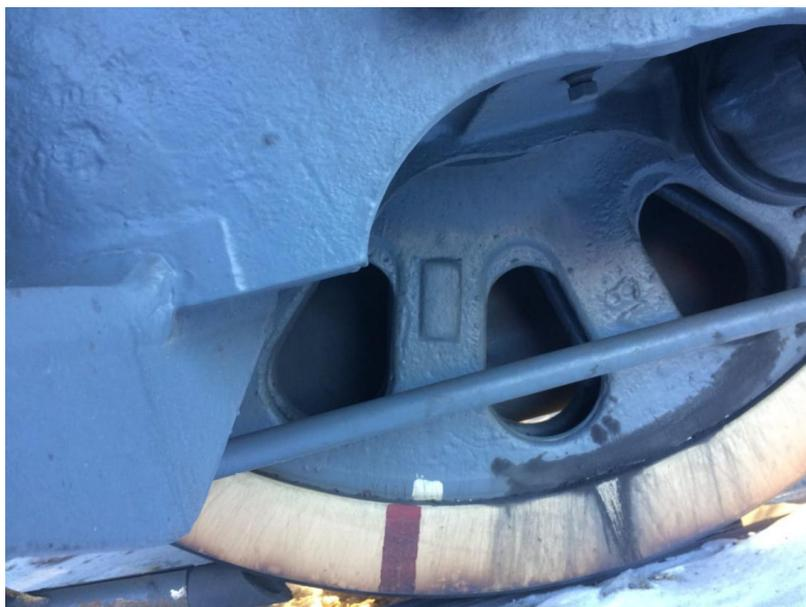
Рис. 1.10 Проворот бандажа колесной пары электровоза 3ЭС5К
