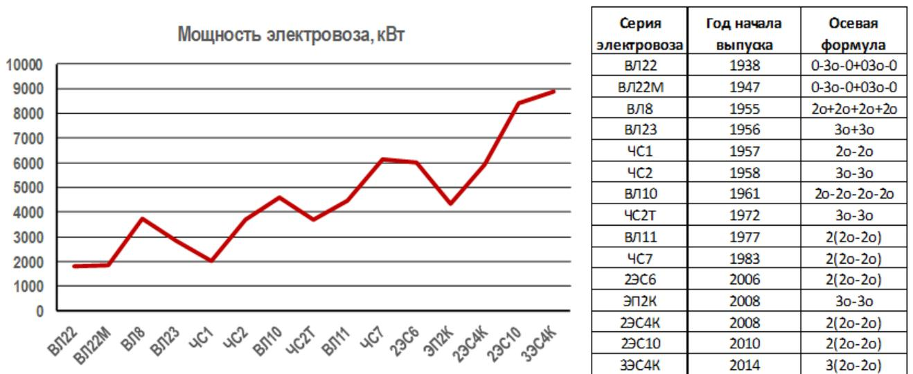
Рис. 1.1 Мощность электровозов постоянного тока в продолжительном режиме работы
