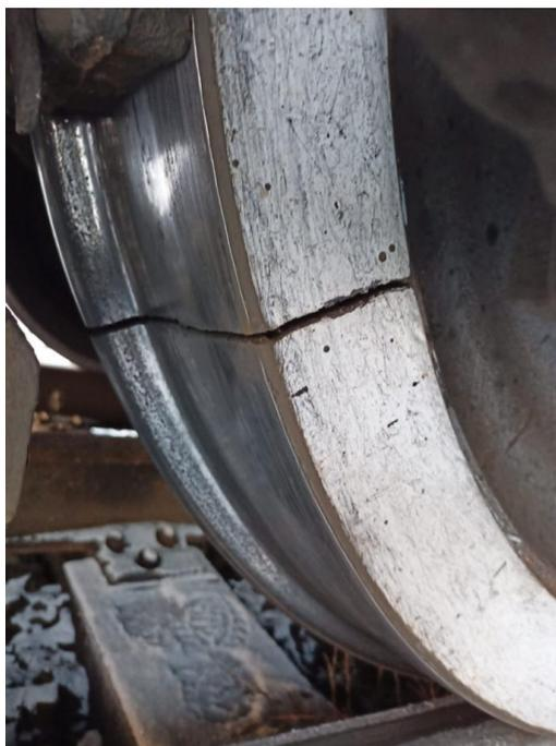
Рис. 1.11 Поперечная трещина бандажа электровоза 3ЭС5К
