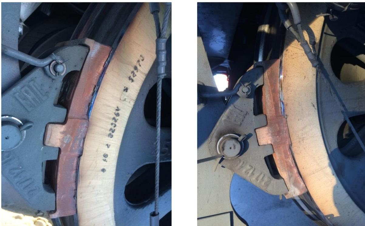
Рис. 1.7 Локальный перегрев поверхности катания бандажа и поверхности тормозной колодки электровоза ЗЭС5К
