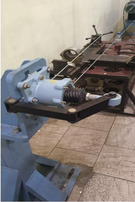
Рисунок 5.4 – Общий вид испытательного стенда механизма управления стабилизатора
