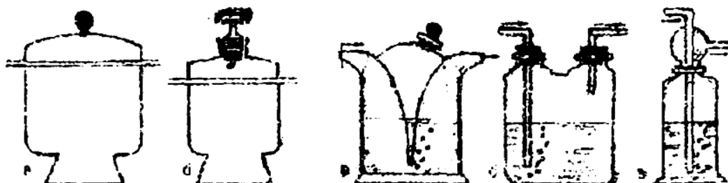
Рис. 5. Эксикаторы: а – обычный; б – вакуумный
