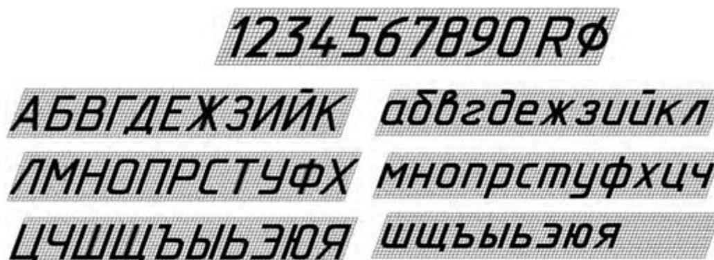
Рис. 4 - Шрифт типа Б с наклоном  $75^\circ$ .
