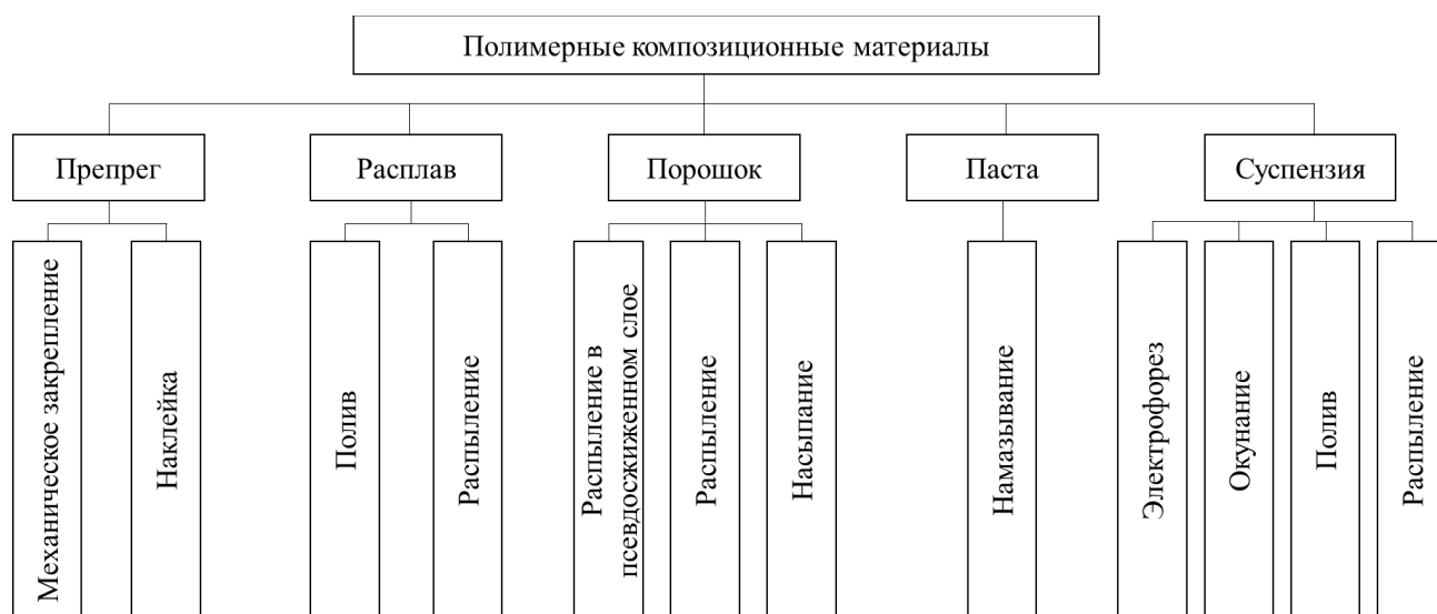
Рисунок 1.3 – Исходные материалы и технология нанесения композиционных полимерных покрытий
