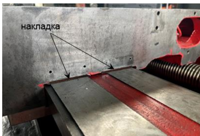
Рисунок 5.7 – Установленные накладки направляющих горизонтально-расточного станка модели 2А622
