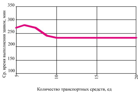
Рисунок 2.39 — Зависимость среднего времени выполнения заявок от количества ТС для системы доставки грузов с помощью складных контейнеров
