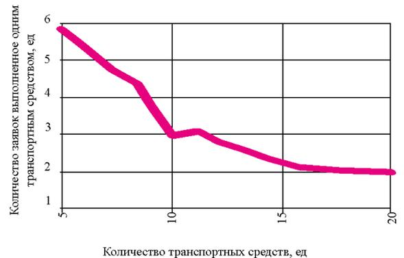
Рисунок 2.40 — Зависимость количества заявок на перевозку, выполненных 1 ТС, от количества ТС для системы доставки грузов с помощью складных контейнеров
