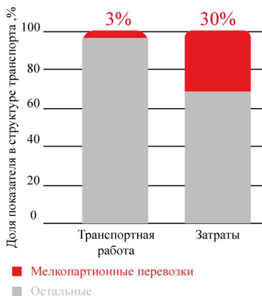
Рисунок 1.3 — Транспортная работа и затраты при осуществлении мелкопартионных перевозок
