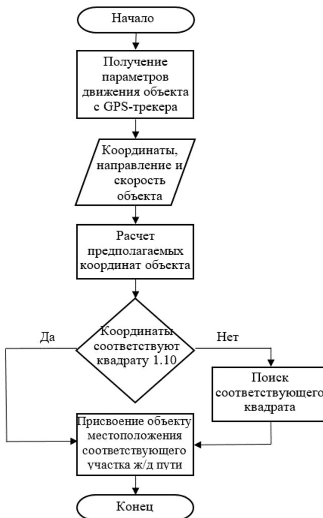
Рис. 3.5 – Блок-схема алгоритма определения местоположения ПЕ ЖДТ в случае временного пропадания сигнала GPS-трекера
