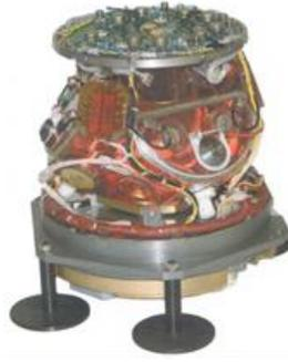
Рисунок 1.7 – Трехосный лазерный гироскоп ТЛГ-1
