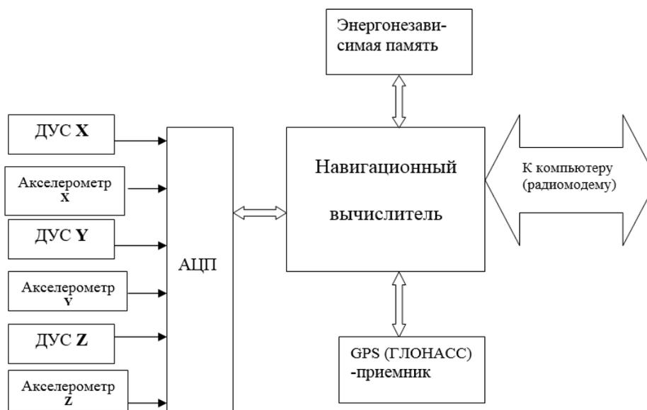
Рисунок 1.1 – Структурная схема ИНС
