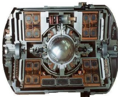
Рисунок 1.5 – Электростатический гироскоп
