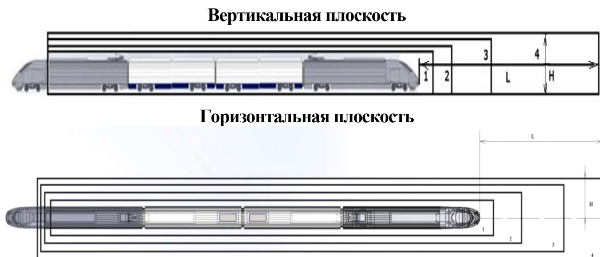
Рисунок 2.10 – Конфигурация зон распределения скоростей в потоке
