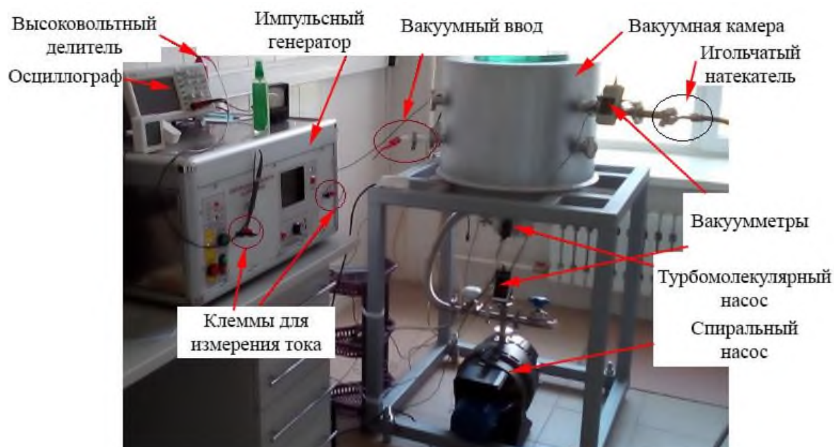
Рисунок 3.1 – Фото установки ионно-плазменной имплантации [202]
