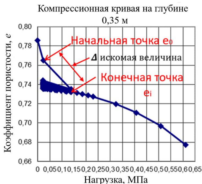
Рисунок 4.5 – Пример выбора необходимых точек на компрессионной кривой для определения относительной деформации расчетного грунтового слоя
