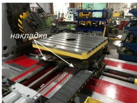
Рисунок 10 – Фотографии направляющих и расположения композиционных накладок
