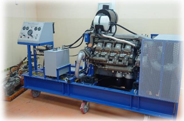
Учебный тренажер «Действующий двигатель КАМАЗ-740»
